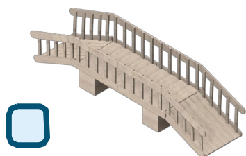
Pont à poutres
